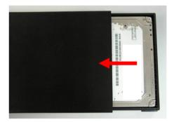
Montez la plaque du disque dur au boîtier métallique, en insérant 2 des plus petite vis (inclus dans l'emballage), dans chaque côté du boîtier. Fixez-les à l'aide du Tournevis inclus dans l'emballage
