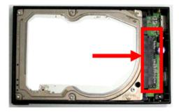
Montez le disque dur dans la plaque en insérant 4 des plus grandes vis (fournies dans l'emballage), dans le fond de la même. Fixez-les à l'aide du tournevis (inclus dans l'emballage).
